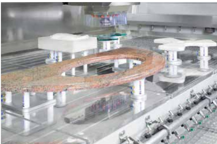
Banco di lavoro in alluminio con ventose e battute Aluminum work table with vacuum and rollaway back stops
