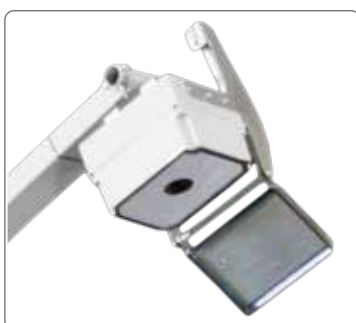
Fotocamera per acquisire foto della lastra Camera slab capture
