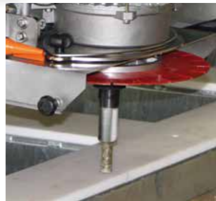
90 degree cutting - Taglio a 90° Tool ½ Gas connection with water flow inside Attacco utensile ½ Gas con gestione acqua interna
