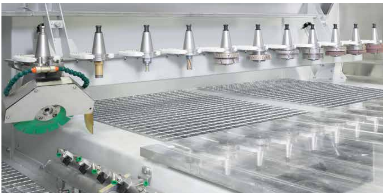
Magazzino utensili automatico 11+11 posizioni Automatic tools store with 11+ 11 positions
